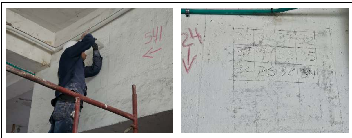
Ilustración 22 Realización del ensayo de índice esclerómetro en piscina niños
