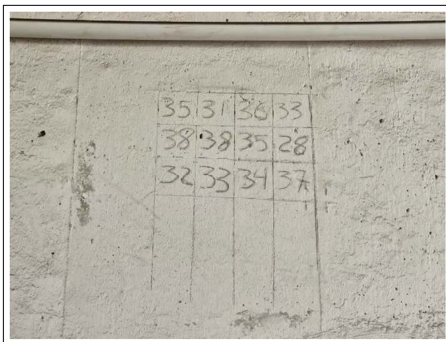
Ilustración 15 Realización del ensayo de índice esclerómetro en columna 1
