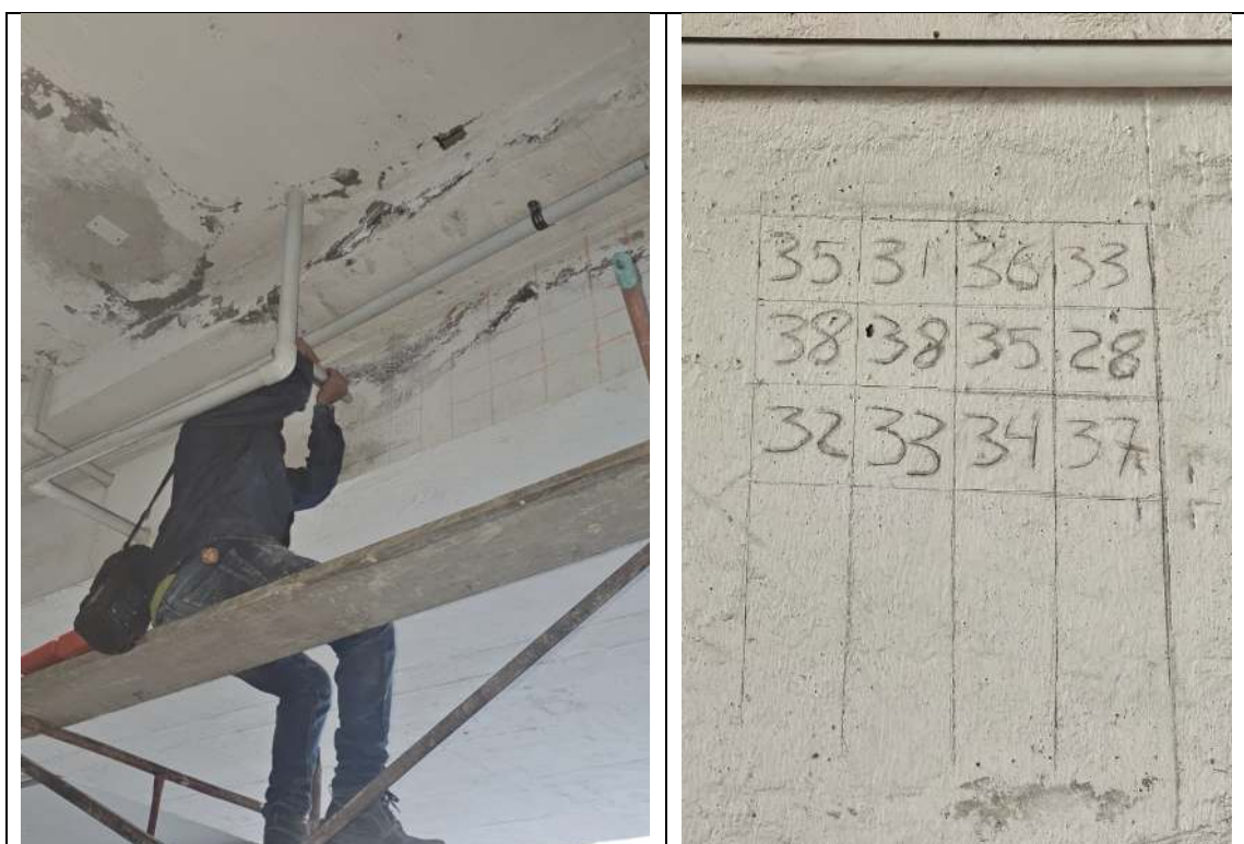
Ilustración 21 Realización del ensayo de índice esclerómetro en piscina niños
